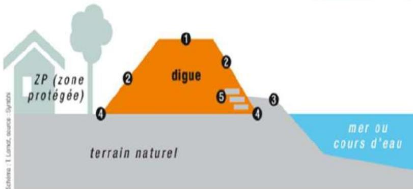
1 Crête de digue supportant généralement une piste. 2 Talus de digue : talus aval côté ZP, talus amont côté eau. 3 Berge. 4 Pied de digue. 5 Protection anciennes : perré, lauzes...
